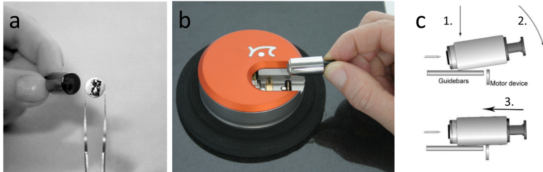
Abbildung 4.2: Probe einlegen: a) Probe auf magnetischem Probenplättchen zentral auf den Shuttle positionieren. b) Einlegen des Shuttle in das STM. c) Reihenfolge der einzelnen Schritte des Einlegvorgangs [9].
